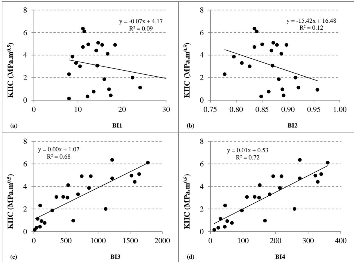
Figure 3. Variation in  $K_{IIC}$  values with (a)  $BI_1$ , (b)  $BI_2$ , (c)  $BI_3$ , and (d)  $BI_4$ .
